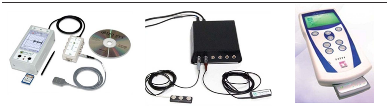
Рис. 4. Различные системы телеметрической электромиографии (слева на право Delsys, B&L Engineering, Mega 6000)
